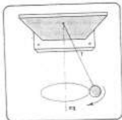
Masa oscilante en un péndulo cónico.
