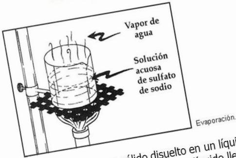
Se utiliza para separar un sólido disuelto en un líquido dejando calentar la muestra hasta que el líquido llega a su punto de ebullición y se evapora totalmente; por ejemplo, una sal con agua.
