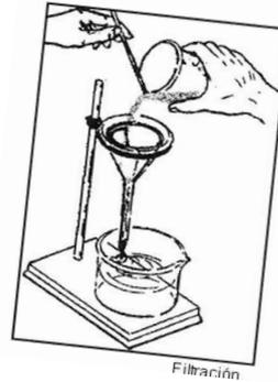
Método o técnica para separar un líquido de un sólido que no se disuelve en él; por ejemplo, el agua con arena.
